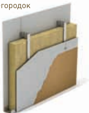
Система межкомнатных перегородок
