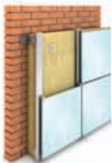
Система вентилируемого фасада
