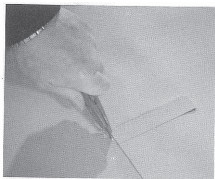
Рис. 17. Вырезка образцов для испытания шва.
